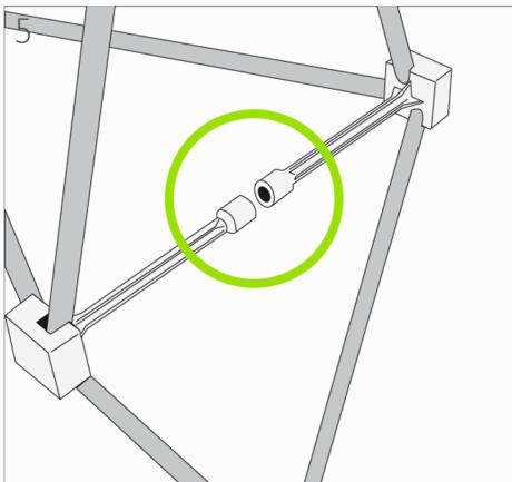
Les connecteurs magnétiques puissants, permettent à la structure une ouverture automatique en quelques secondes.
