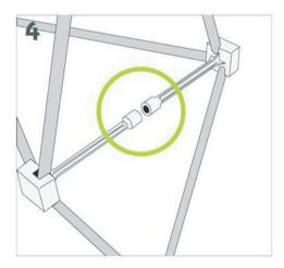
Die kraftvollen Magnetverbinder ermöglichen ein automatisches Schließen der Struktur in wenigen Sekunden.
