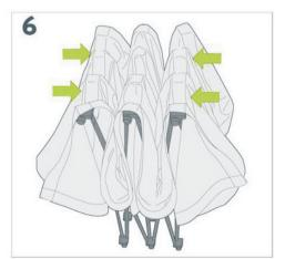
Um die Konstruktion abzubauen, müssen Sie die Magnetverbinder trennen und die Struktur hoch klappen. Die Grafik bleibt auf dem Rahmen. Stellen Sie deshalb sicher, dass die Grafik beim Falten angehoben wird, damit sie nicht im Rahmen einklemmen kann.
