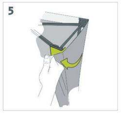
Wickeln Sie die Enden um die Seiten des Rahmens und befestigen Sie den Druck am Klettverschluss auf der Rückseite.
